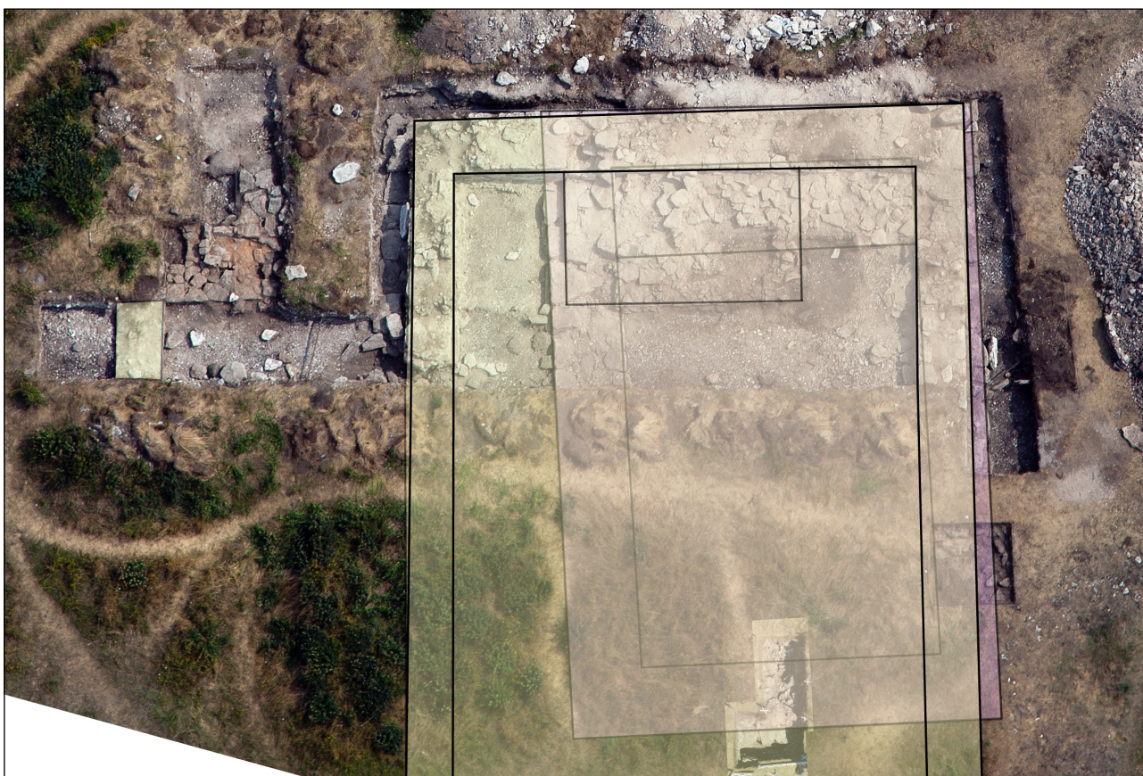
Figur 31. De två byggnadskonstruktioner som kan beläggas på platsen. Överst (svagt gult markerat) är den senare kyrkan, bestående av en rektangulär byggnadskropp om ca 30 x 13 meter. Murarna är drygt 1 meter breda, väl byggda och hopfogade med murbruk. Ett altare finns centralt i den östra kortväggen, uppbyggt troligen i två nivåer. I norr finns en tillbyggnad, där stora delar av den förefaller vara raserad av senare verksamheter, troligen framför allt under 15- och 1600-tal. Murarna är ca 1 meter breda men, där de har kunnat beläggas, betydligt grundare än själva kyrkan. Stratigrafiskt under kyrkan finns en byggnad bestående av en 1,8 meter bred skalmur (markerad med svagt lila färg). Byggnaden kan uppskattas till 10 x 7 meter stor, någon vinklad i förhållande till den övre kyrkan. En stenpackning i östra delen längs hela östra gaveln kan ha varit någon form av altare.
